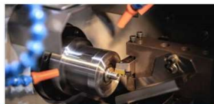
加工（シリンダ部分の切削）
