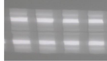
ず シャゼウセイ コウジョウ トソウメン 図-2 写像性が向上した塗装面
